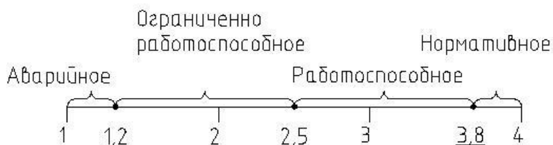
Рис.5. Шкала ранжирования категорий технического состояния несущих конструкций
